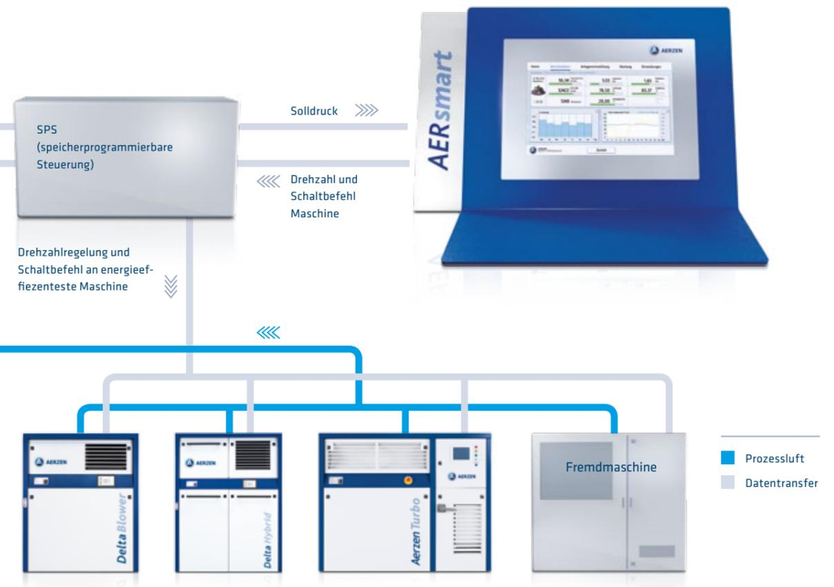
AERsmart bietet umfangreiche und flexible Möglichkeiten zur Einbindung in das Prozessleitsystem.
