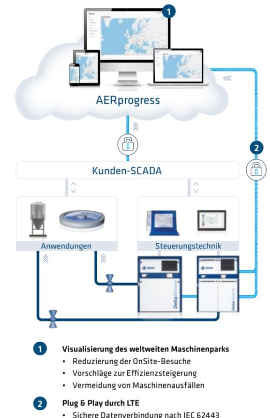
■ Prozessluft   ■ Datentransfer   ■ LTE-Daten
